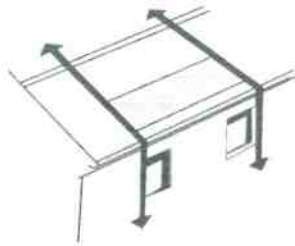
Implantation horizontale. Alignement du champ de capteurs avec les ouvertures en façade
